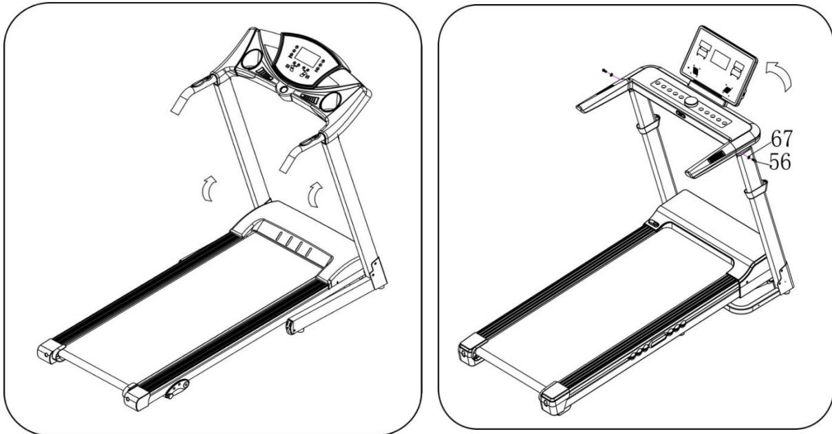
1. С помощью шестигранного ключа (10), шестигранного винта (56) и стопорной шайбы (67) зафиксируйте консоль на вертикальной стойке с левой и правой стороны.
