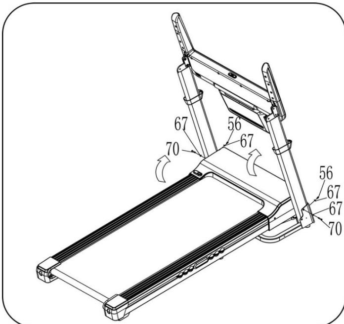
1. Удерживая вертикальную стойку рукой, используйте шестигранный ключ (10), шестигранный винт (70) и стопорную шайбу (67), чтобы установить вертикальную стойку.
