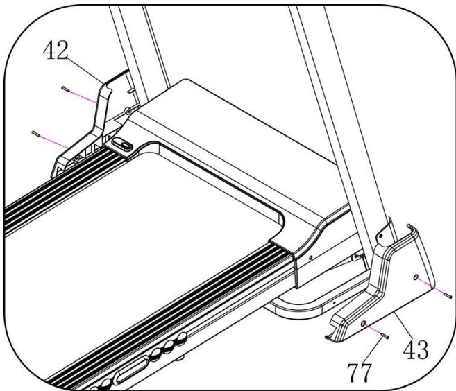
1. Закрепите кожух основания с правой стороны (42) с помощью винта, ключа (12) и самореза (77).
